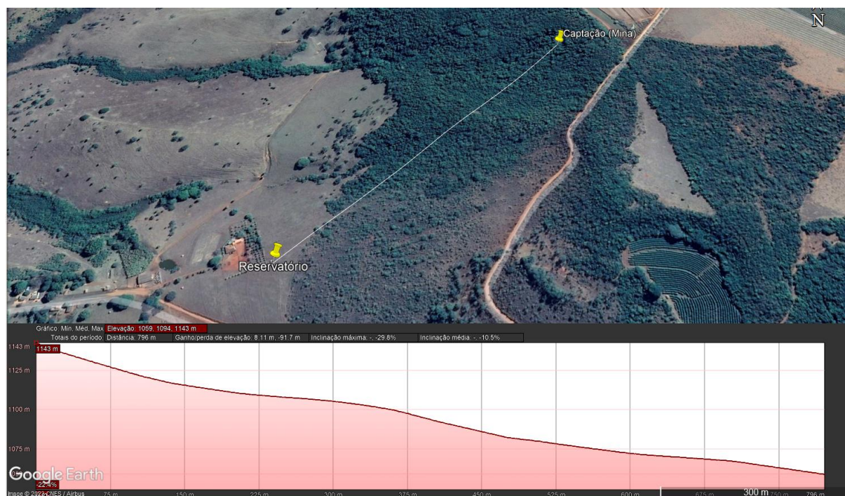
Figura 44 – Desnível entre a captação e o reservatório
