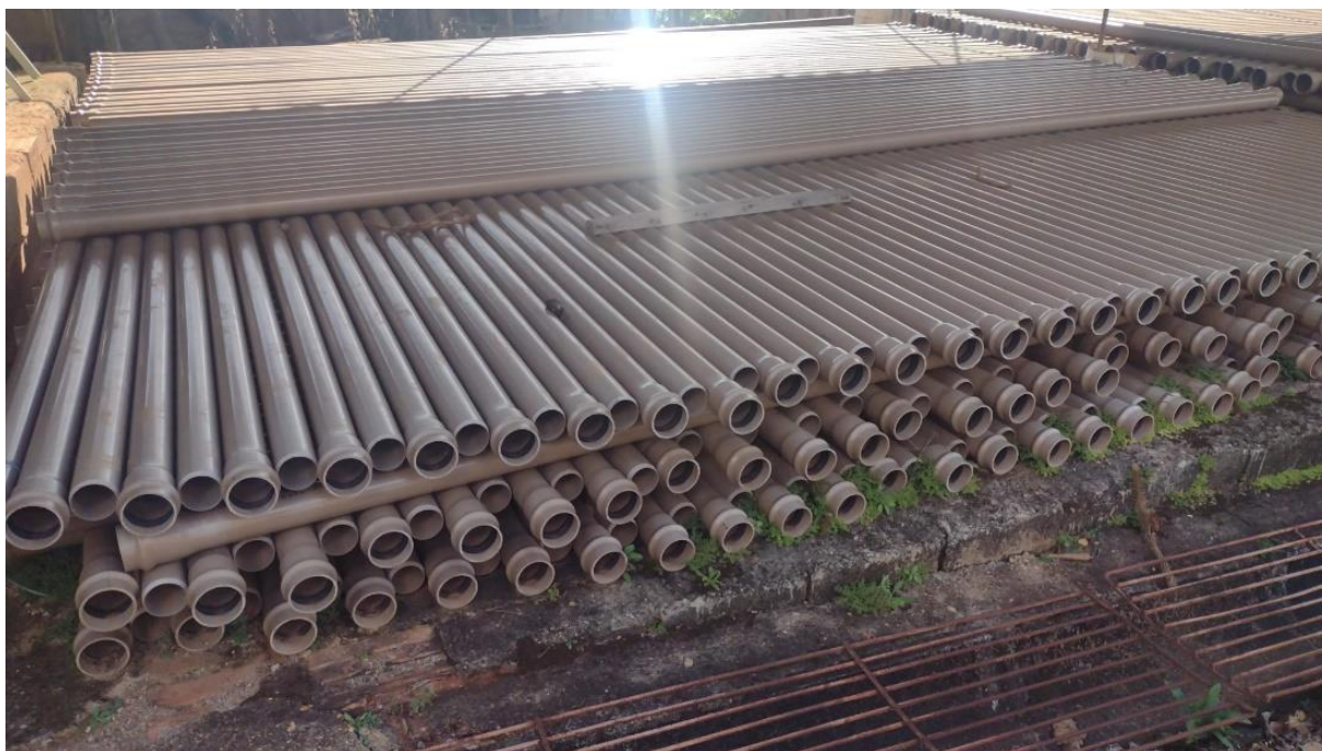
Figura 175 – Estoque de tubos PVC utilizados em redes de distribuição
