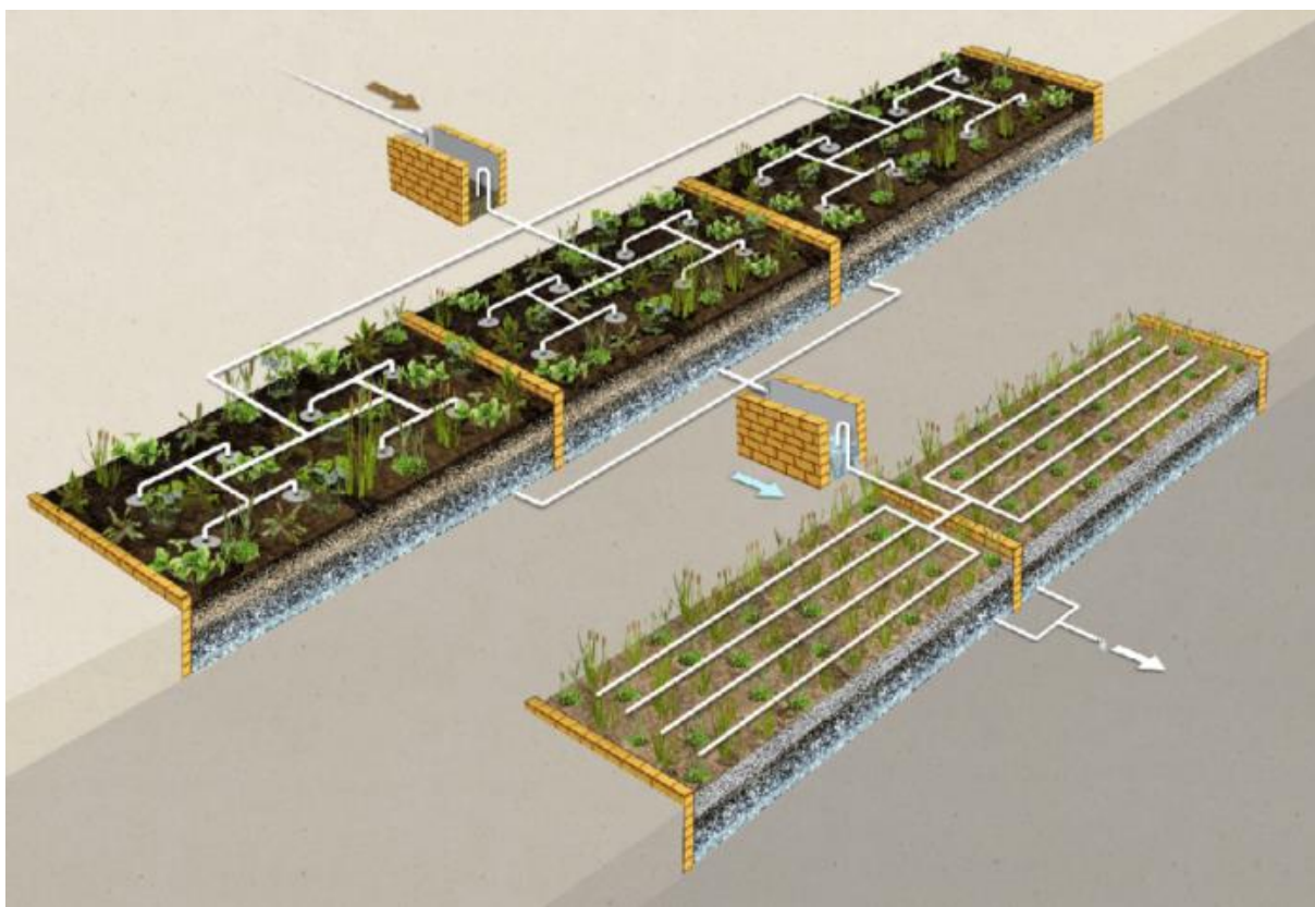
Figura 253 – Esquema de Wetland vertical – Sistema francês
