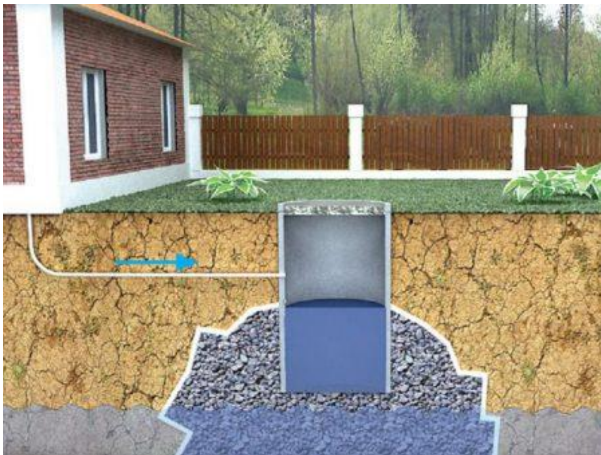
Figura 205 – Modelo de fossa rudimentar individual
